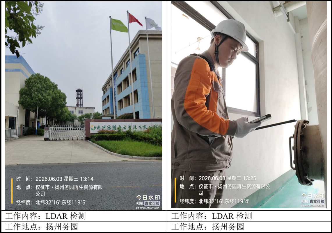
图 4.3-1 LDAR 检测人员现场作业照片
